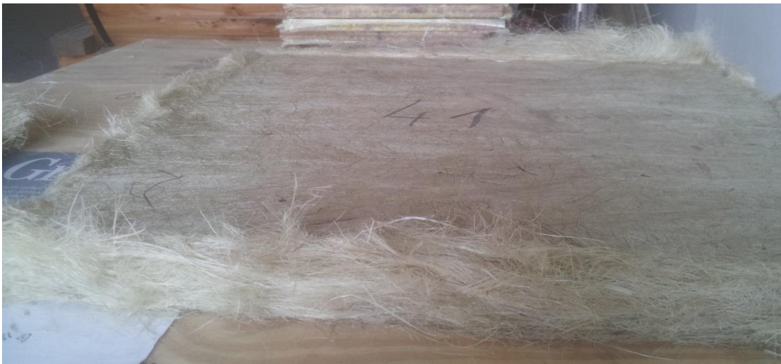
Abb. 3 : Mit Sisal-Fasern verstärkte OSRB-Platte
